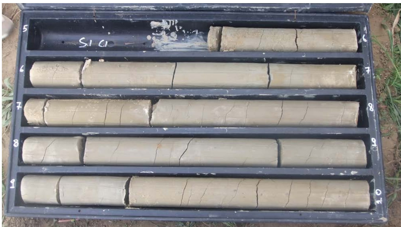
Sondaggio S1 – Cassa 2 – da 5,00 a 10,00 m dal piano di campagna
