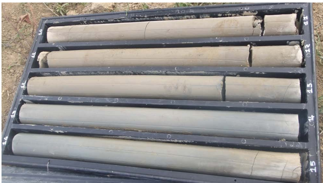
Sondaggio S3 – Cassa 3 – da 10,00 a 15,00 m dal piano di campagna
