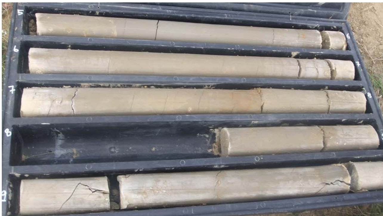
Sondaggio S3 – Cassa 2 – da 5,00 a 10,00 m dal piano di campagna
