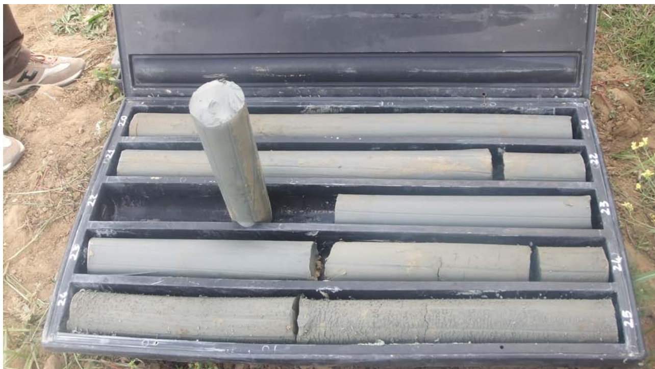
Sondaggio S1 – Cassa 5 – da 20,00 a 25,00 m dal piano di campagna
