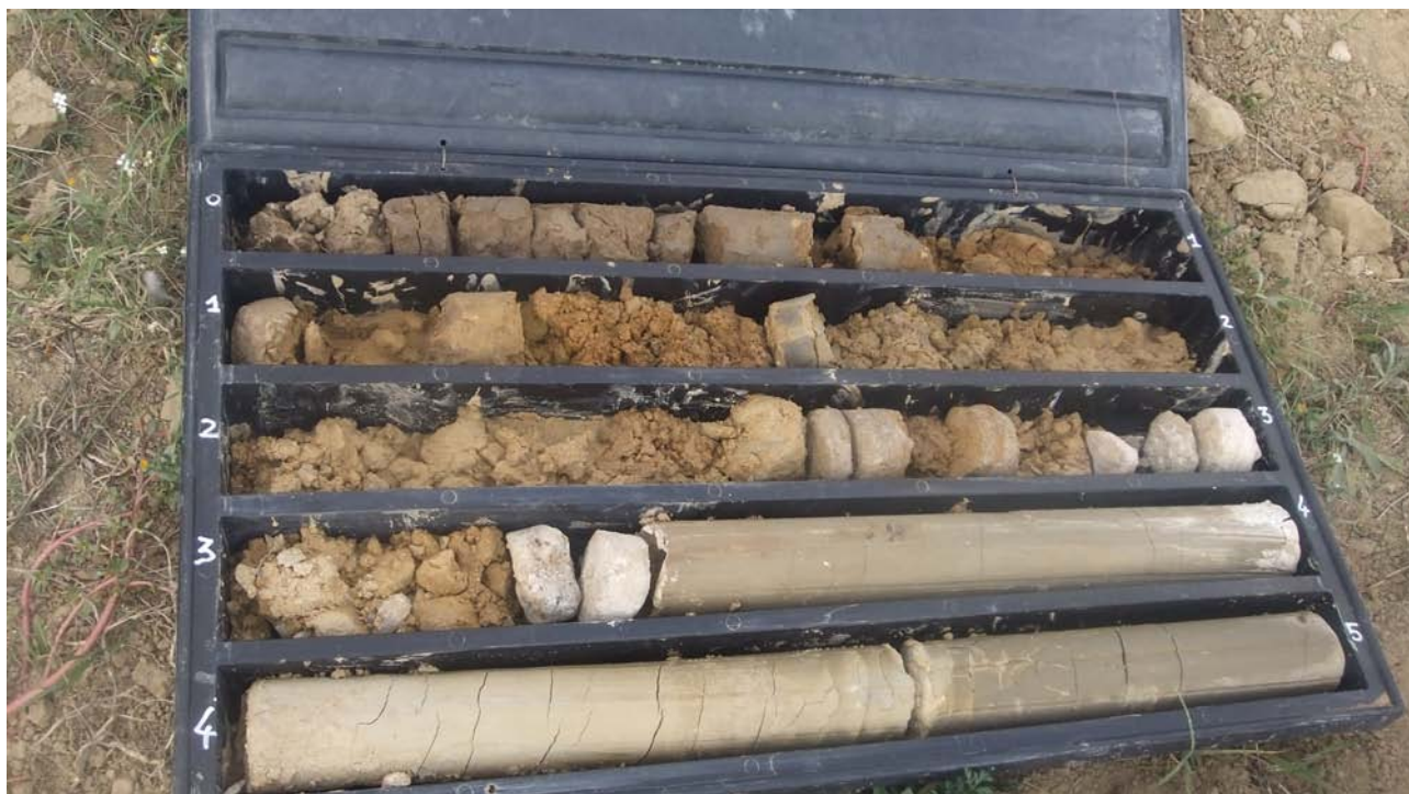
Sondaggio S3 – Cassa 1 da 0.00 a 5.00 m dal piano di campagna
