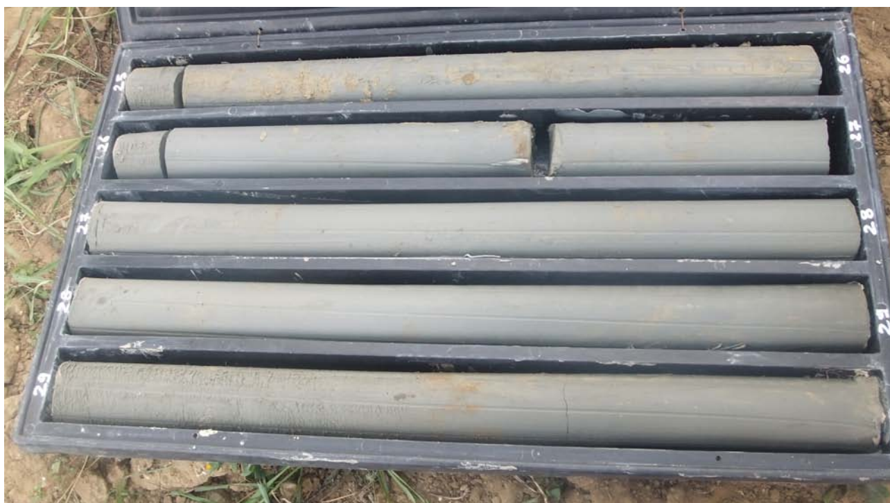
Sondaggio S1 – Cassa 6 – da 25,00 a 20,00 m dal piano di campagna
