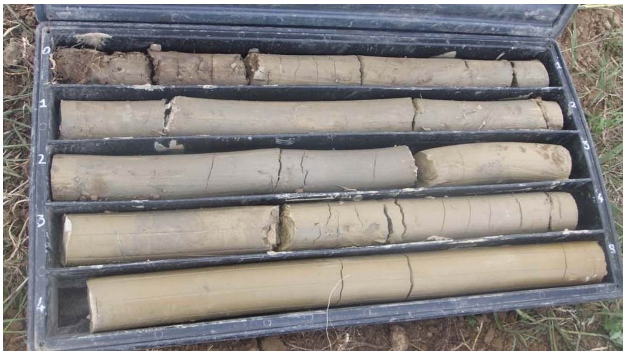
Sondaggio S2 – Cassa 1 da 0.00 a 5.00 m dal piano di campagna
