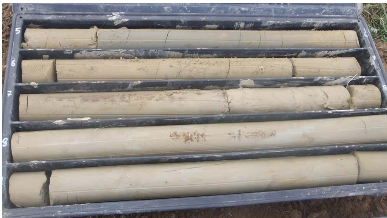
Sondaggio S2 – Cassa 2 – da 5,00 a 10,00 m dal piano di campagna
